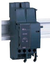
MN Расцепитель минимального напряжения с выдержкой времени
