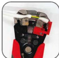
Правильная разделка кабеля и снятие изоляции с провода без повреждения токоведущей жилы являются основой качественного электромонтажа.
