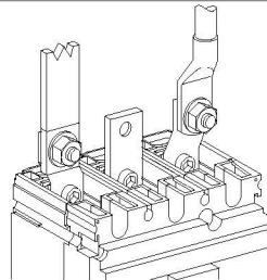
6. Размеры внешних проводников для BA-99 EKF PROxima (посеребренная медь, поставляются в комплекте с выключателем). Подвод напряжения от источника питания допускается как сверху, так и снизу выключателя. Длина проводников 30–40 мм.
