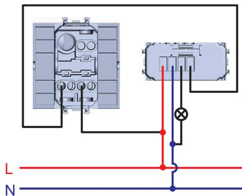
Схема подключения датчика движения с возможностью отключения.
